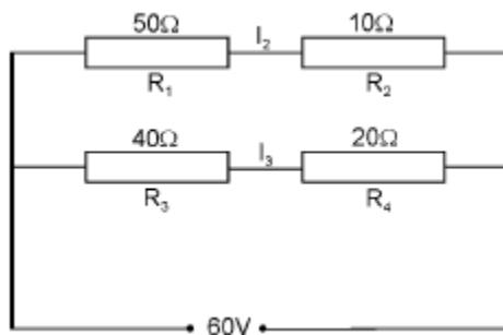
No circuito representado, a razão  $I_2/I_3$  , entre as intensidades de corrente elétrica nos resistores  $R_2$  e  $R_3$ , é:
