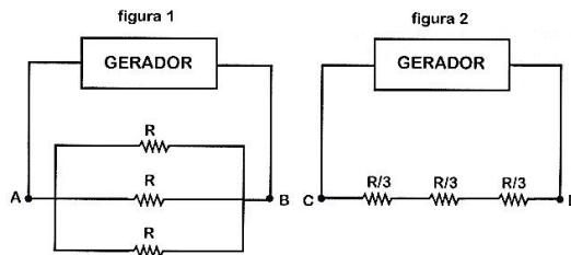
Sendo  $P_1$  a potência dissipada em um dos resistores existentes entre A e B e sendo a potência total dissipada entre C e D, a relação entre  $P_1$  e  $P_2$  é dada por:
