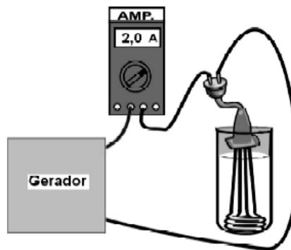
Existem, inicialmente, 400 g de água a 20 °C dentro do recipiente. Desconsidera-se o calor absorvido pelo recipiente e pelo ebulidor, que possui resistência de  $420 \Omega$ . Considera-se que:
