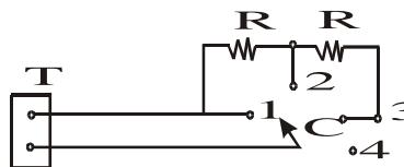
Os terminais do chuveiro estão ligados a uma tomada T, como indica a figura abaixo. Para obter as situações I, II e III, a chave C deve ser posicionada, respectivamente, nos pontos
